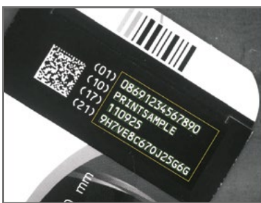
Rotationstolerante Druckinspektion und Inkrementalnummernprüfung
