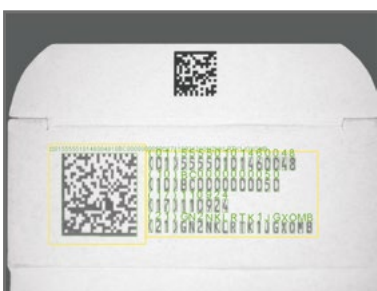
Track & Trace Anwendung von GS1-Datenmatrix und menschenlesbarer Textkonsistenz (gleicher Dateninhalt) mit zusätzlicher Data Matrix Qualitätsprüfung nach ISO 15415
